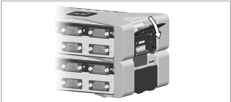
Abb. 6.8 Hebel schließen
