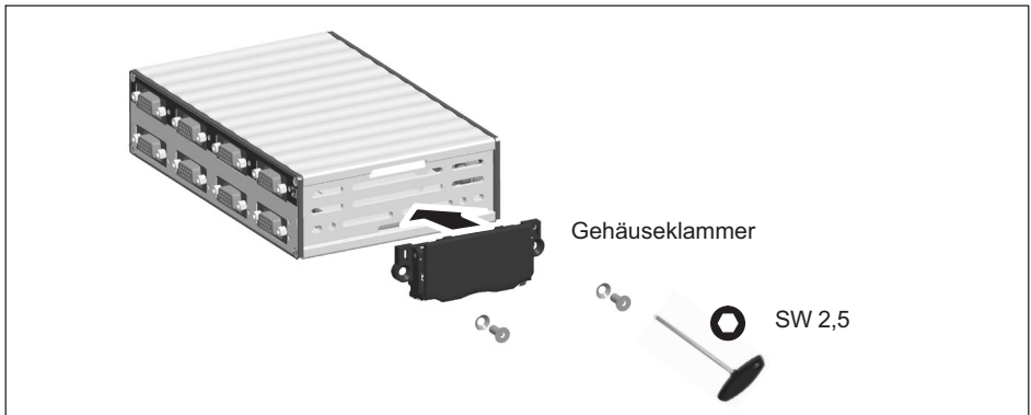
Abb. 6.4 Gehäuseklammer CASECLIP montieren
